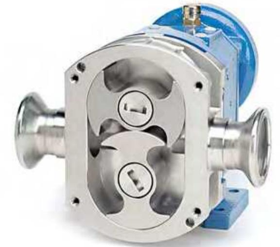
Die hygienische Drehkolbenpumpe BE in Blockausführung vereint alle Vorteile der Standardausführung der Drehkolbenpumpe der Baureihe B mit dem Vorteil des geringeren Platzbedarfs und weniger Ersatzteile, da der Antriebsmotor direkt an die Pumpe angeflanscht wird.
