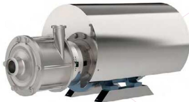
Die Baureihe CSM ist aus massivem Edelstahl 1.4404 (316L) gefertigt und verfügbar in bis zu 4 stufigem Design mit offenem Laufrad mit einem maximalen Betriebsdruck von 40 bar. Wesentlicher Vorteil ist der Betrieb mit hohen Eingangsdrücken und Druckerhöhung.
