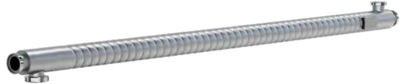
Wärmetauscher in Hygienic Design bestehend aus zwei konzentrischen angeordneten Wellrohren. Großer freier Durchgang im Produktrohr. Mantelrohr mit oder ohne Kompensator.
