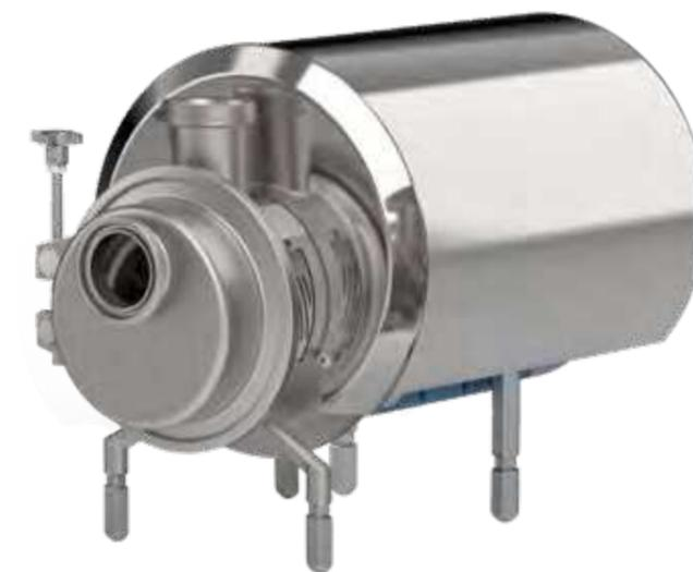
Seitenkanalpumpe aus Edelstahl 1.4404 (316L) in Blockbauweise ausgeführt. Separat gelagerte Pumpenwelle zum Betrieb mit IEC Normmotor. Mit einfacher oder doppelter Gleitringdichtung. Sehr gute Saugleistung bis 7,5m. Weit verbreitet für CIP Rücklauf oder Entladung von Tanks oder im Handling von Flüssigkeit mit hohem Gasanteil.
