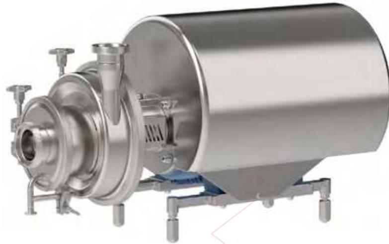
Auf Basis der CN Pumpe entwickelte selbstansaugende Hybridpumpe mit 3A Zulassung. Deutlich geringere Geräuschemission und höhere Effizienz als bei Seitenkanalpumpen machen die CNH zum perfekten Partner bei Anwendungen mit zweiphasigen Medien. Komplett aus Edelstahl 1.4404 (316L) gefertigt mit polierter Oberflächen, ohne Toträume und rückstandslos mittels CIP/SIP reinigbar.
