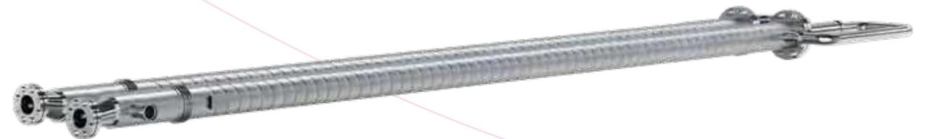
Der Mixflo Annular Space Röhrenwärmetauscher besteht aus mehreren konzentrisch angeordneten Wellrohren. Das Produkt wird dabei von innen und außen geheizt oder gekühlt. Der verschachtelte Aufbau ermöglicht eine große Wärmeaustauschfläche bei relativ kleinen äußeren Abmaßen.
