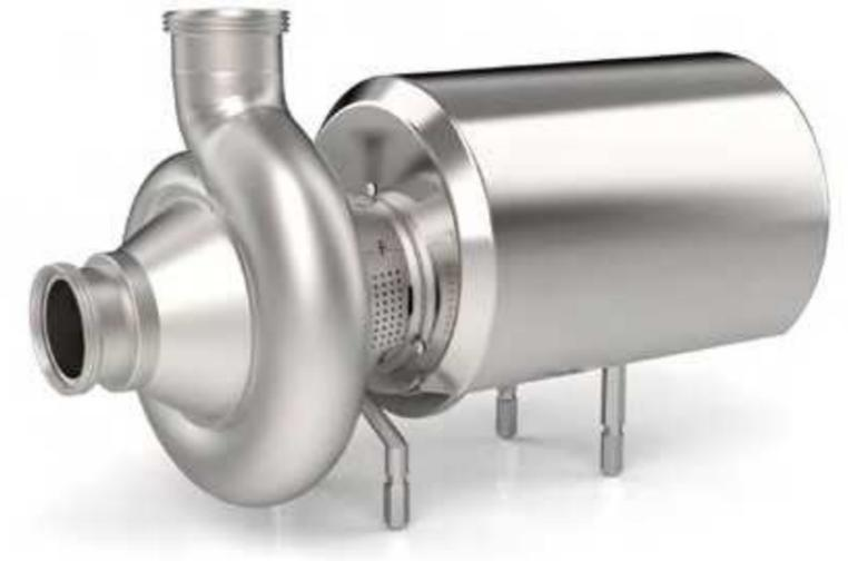
Die CR Baureihe zeichnet sich aus durch die Verwendung eines Axiallaufrads in Kombination mit einem speziell ausgeprägtem Gehäuse für großen freien Durchgang. Der Antrieb mit geringer Drehzahl (max. 1750 1/min) und die Bauform ermöglichen eine sanfte Beförderung von Flüssigkeiten mit Feststoffen wie beispielsweise in der Weinherstellung, bei der Beförderung von Obst und Gemüse und ähnlichen Anwendungen.
