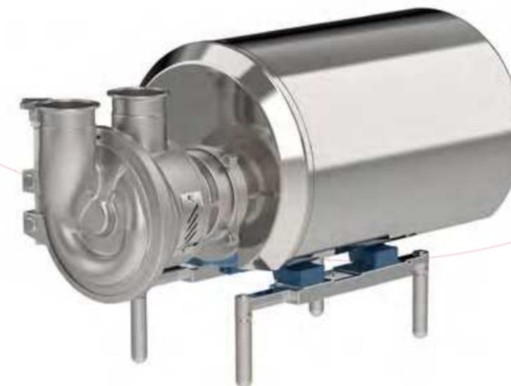
Selbstansaugende Seitenkanalpumpe mit 3A Zertifizierung aus Edelstahl 1.4404 (316L) gefertigt. Reversibler Betrieb möglich durch integrierte Bauform und nach oben ausgerichteter Stutzen. Alle medienberührten Oberflächen standardmäßig in polierter Ausführung Ra < 0,8 µm.
