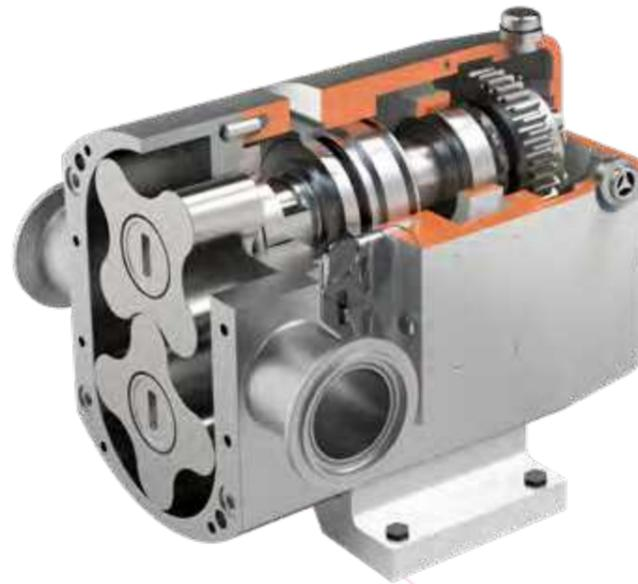
Die hygienische Drehkolbenpumpe C wurde entwickelt mit dem Fokus auf Servicefreundlichkeit ohne auf bewährte Features anderer Baureihen zu verzichten. Von vorne wechselbare Gleitringdichtungen, einfaches Einstellen der axialen Spaltmaße und kompromissloses Umsetzen von Hygienic Design zeichnen die Pumpe aus. Alle medienberührten Bauteile in 1.4404 oder 1.4435 (AISI 316L) ausgeführt. Die Pumpe ist EHEDG und 3A zertifiziert.
