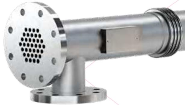
Der Crossflo Wärmetauscher ist aufgebaut aus einem Rohrbündel gewellter Rohre, die in einem Mantelrohr montiert sind. Die Rohre sind integral am Rohrboden verschweißt, der Mantel ist mit einem Kompensator ausgestattet um thermische Spannung zu vermeiden. Dank Einsatz von Wellrohren hoher thermischer Wirkungsgrad.
