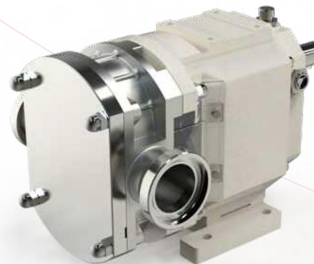
Die Baureihe BA (3A & EHEDG zertifiziert) bzw. BB ist eine auf Basis der B Serie entwickelte Ausführung mit verbessertem hygienischen Design bei gleichen hydraulischen Leistungsdaten und identischem Lagerträger. Rückstandslos reinigbare Ausführung durch versenkte Rotorschrauben und spaltfreier Ausführung der Gleitringdichtung und O-Ringe. Die Pumpen sind aus komplett aus Edelstahl 1.4404 (AISI 316L) gefertigt und weisen einen hervorragenden Wirkungsgrad auf.
