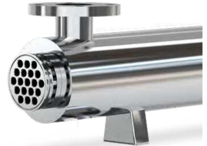
Der Rohrbündelwärmetauscher Pharmaflo in Sterilausführung ist konstruiert um die höchsten Anforderungen an Reinheit zu erfüllen. Ausgestattet mit doppeltem Rohrboden (DTS - double tube sheet), nahtlos gezogenen Rohren und (elektro)polierten Oberflächen. Komplett aus Edelstahl 1.4404 oder 1.4435 (316L) gefertigt.
