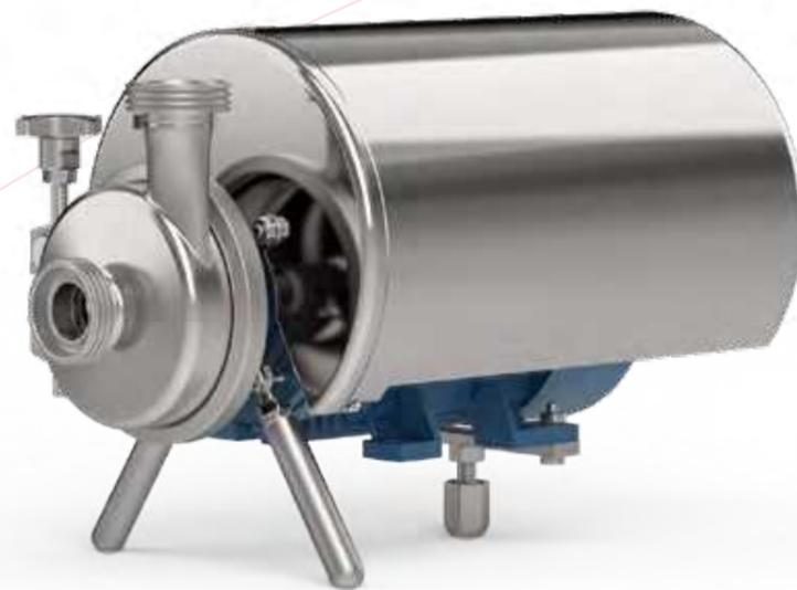
Einfache und kosteneffiziente Pumpenbaureihe aus Edelstahl 1.4404 (AISI 316L) mit polierter Oberfläche gefertigt. Verfügbar mit offenem (CL) oder geschlossenem (CLC) Laufrad für einfache Wasseranwendungen oder als CIP Pumpe. Kompakte Blockbauform mit direkt auf Motorwelle montiertem Laufrad.
