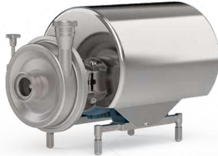
Einstufige Baureihe mit Gehäuse aus tiefgezogenem Walzstahl 1.4404 (AISI 316L) für verbesserte Oberflächengüte und Gewichtsreduktion. Pumpe mit separater Pumpenwelle und offenem Laufrad. Betrieb am Normmotor. Baureihe EHEDG & 3A zertifiziert. Komplett aus Edelstahl gefertigt für eine Vielzahl an Anwendungen.
