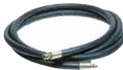
DAMPFSCHLAUCH AUS GUMMI Arbeitsdruck 10 Bar bei 120°C Explosionsdruck 30 Bar bei 120°C Temperaturbereich -30°/+120° 3/4" (Ø 19x30) - 1" (Ø 25x38)
