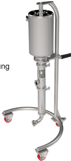
Pneumatische Kolbenpumpe in kurzer Ausführung mit Abstreifplatte zum Entleeren von Fässern oder zylinderförmigen Behältern. Für Produkte mit hoher Viskosität.
